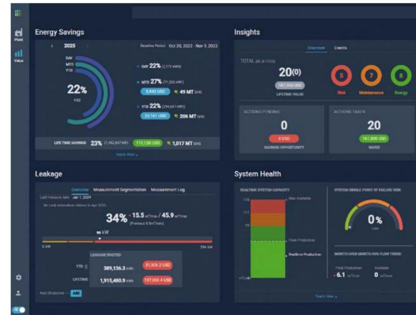
Valore generato da ECOPLANT360: risparmio energetico, intuizioni fornite da IA e allarmi, funzione calcolo perdite di aria e funzione monitoraggio "System Health".
