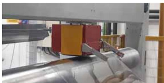
Sistema di misura dello spessore, ad aria compressa.
