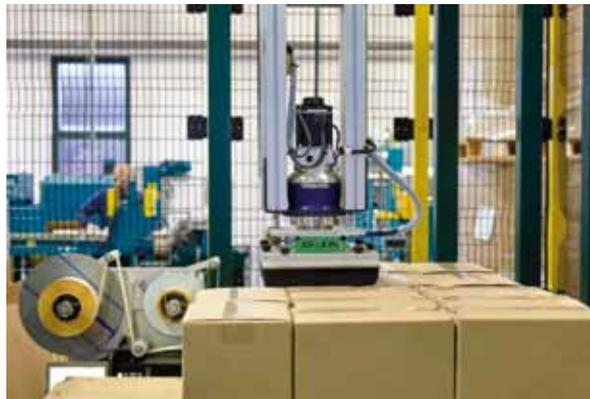
I gripper Kenos® KVG di Piab impiegato nell'impianto di Eklego per prelevare vari componenti e inserirli in scatole di cartone.
