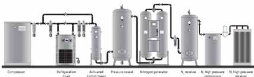
Schema dell'unità completa di generazione di azoto PSA di Omega.
