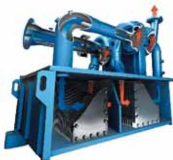
**Il flusso dell'aria in un compressore centrifugo che evidenzia come l'energia cinetica (di velocità) viene trasformata in pressione attraverso i vari stadi.**
