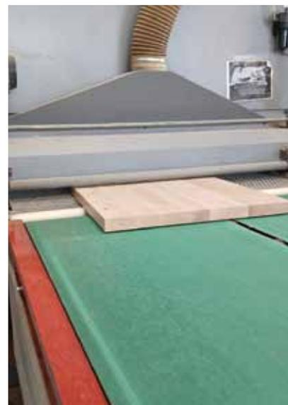
Gizia - processo di calibratura del pannello massiccio.
