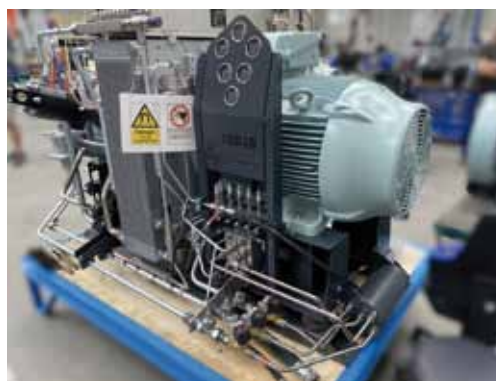
Il nuovo Sauer Orkan con azionamento magnetico.
