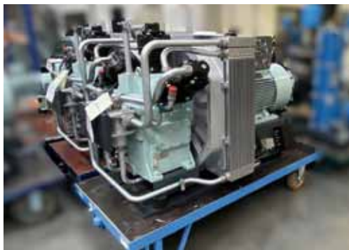
Due compressori pronti per il test di routine (18 ore di funzionamento continuo).
