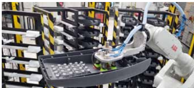
Prelievo della scocca del faretto con ventose piGRIP con labbro FXI 18 shore di Piab nella linea di MVQuadro.
