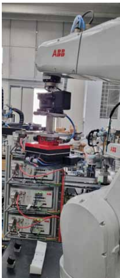
Gripper Kenos KFG di Piab impiegato nella movimentazione della scheda elettronica nella linea realizzata da MVQuadro.
