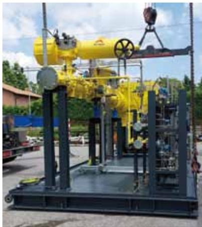
**Compressore fuel gas booster MSG per una centrale in Italia.**
