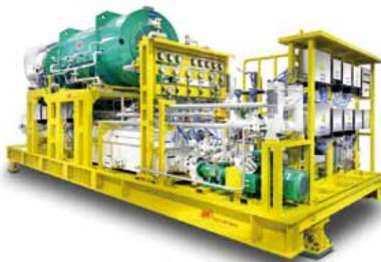
**Compressore centrifugo Centac da 220 m<sup>3</sup>/min a 9 barg per impianto galleggiante di gas naturale liquefatto installato su gimbals per la stabilizzazione offshore.**
