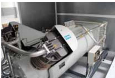
**Compressore Sirius per CO<sub>2</sub> utilizzato nel processo di disinfestazione.**
