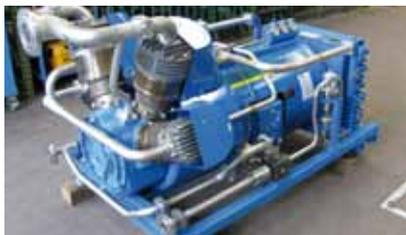
**Compressore Sirius per CO<sub>2</sub> utilizzato nel processo per la rimozione della caffeina.**
