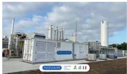
**Generatore azoto PSA in container per l'inertizzazione di una stazione di biometano.**
