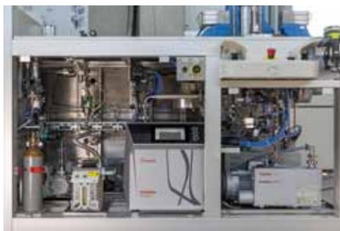
Sistema di prova di tenuta dei raccordi: qui sono implementati un PHOENIX Quadro e una pompa rotativa a palette Leybold NEO D.
