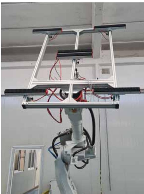
Sistema di presa di Automation Technology con 6 gripper Kenos KVG impiegati nella fase di manipolazione.
