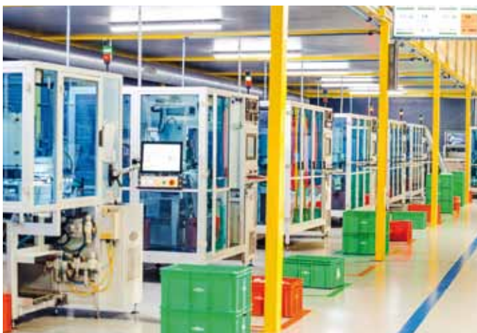
Il reparto di selezione automatica composto da 23 unità operatrici.
