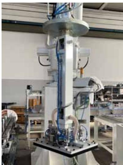
Dettaglio del gripper Kenos KVGL installato nel pallettizzatore dell'impianto per l'insacchettamento di farina di Maxpro.
