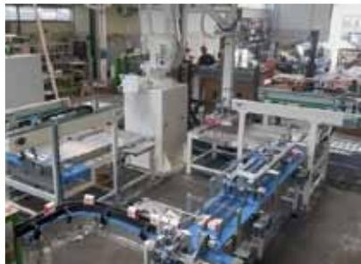
Fine linea dell'impianto per l'insacchettamento di farina di Maxpro con il pallettizzatore equipaggiato con il gripper Kenos KVGL.
