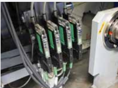
Quattro eiettori piCOMPACT forniscono il vuoto per la movimentazione di siringhe.
