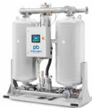
Essiccatore ad adsorbimento serie PB rigenerato a caldo con soffiante e zero aria di purga.
