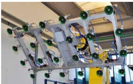
Manipolatore con le ventose a elevato attrito Duraflex, i generatori di vuoto VGS5010 e i dispositivi piSAVE On/Off e piSAVE release di Piab.
