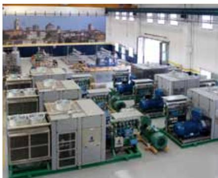
Assemblaggio compressori oil free offshore.
