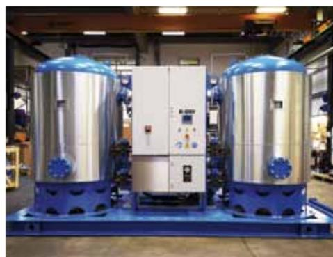
Essiccatore ad adsorbimento modello R-DRY.
