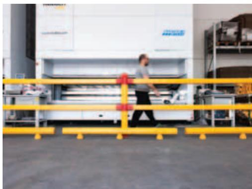
calcolato per resistere all'energia di impatto del veicolo in circolazione, eliminando totalmente il rischio di deformazione o collasso del delimitatore stesso verso il sentiero pedonale. Autoestinguento, riciclabile, resistente ai raggi UV, alle polveri, a getti ad alte pressioni e ad alte temperature: queste le caratteristiche che completano lo standard progettuale proprio della filosofia dell'azienda emiliana.
