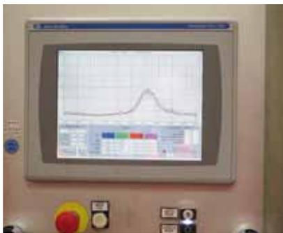
laser. L'operatore può, quindi, confermare o meno la presenza di una perdita e scartare lo pneumatico. Se esso è in buone condizioni, l'operatore può convalidare lo stato positivo del test e permettere allo pneumatico di procedere alle fasi successive del processo di ricostruzione.
