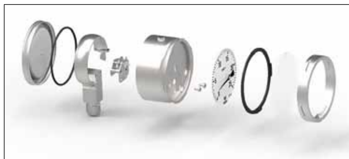
Fig. 2 - Vista esplosa di un manometro di sicurezza (categoria "S3").
