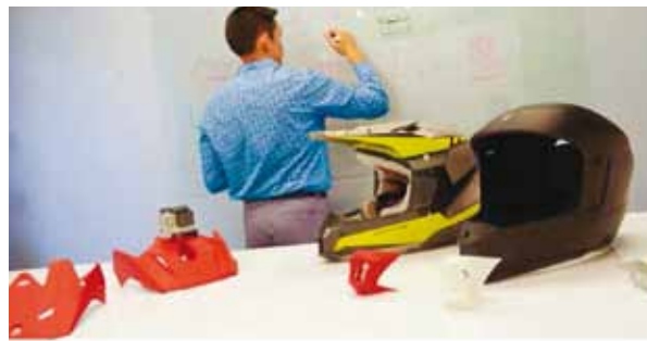
Da sinistra a destra, la montatura per la videocamera da casco, il casco finito, la mentoniera in rosso e bianco e il prototipo del casco in CAD, una delle applicazioni della stampa 3D.
