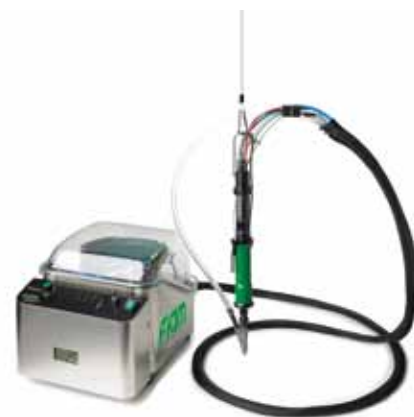
Figura 2 - Sistema di avvitatura semiautomatico CA Easydriver: può essere manuale o integrabile su macchina, è dotato di PLC integrato che relaziona con il sistema fabbrica.
