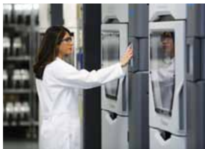
Linea di stampanti 3D Stratasys Fortus 450mc per la costruzione rapida di prototipi e attrezzature per la produzione.
