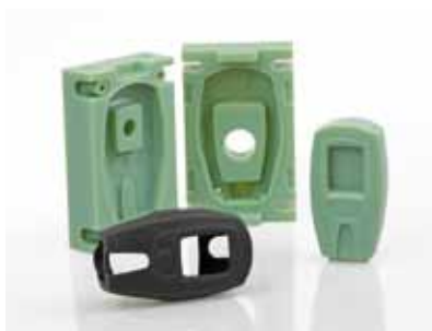
Stampo per stampaggio a iniezione realizzato mediante stampa 3D con Stratasys Connex3 in materiale PolJet Digital ABS.
