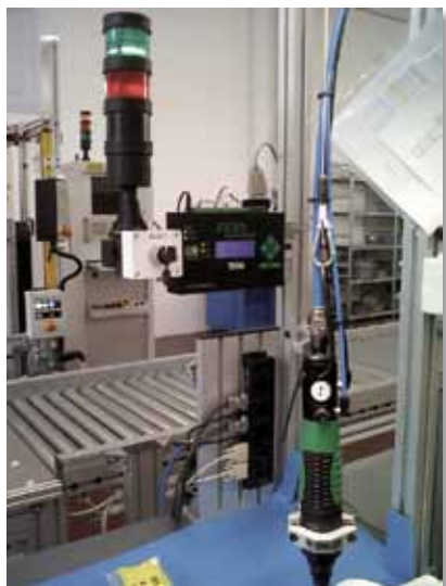
Figura 1 - Unità TOM a bordo linea pallet, abbinata ad avvitatore pneumatico anuale diritto e interfacciata con il PLC della linea.
