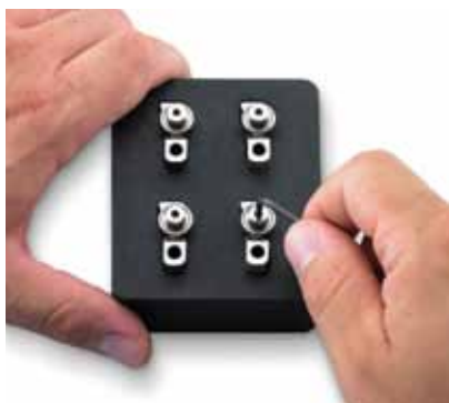
Maschera stampata in 3D con tecnologia Stratasys FDM impiegata per facilitare l'assemblaggio del prodotto.
