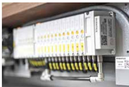
senza intervenire sul gruppo e di modificarlo successivamente grazie alla struttura modulare. Opportunità di cambiamenti post-installazione anche per le Batterie AES 3 E 5 Profinet I/O. Dimensioni contenute con alta portata, qualità e design accattivante sono solo alcune delle peculiarità di questo prodotto, che in un'unica batteria può contenere fino a 64 valvole bistabili e gestire 512 I/O. E' stata, inoltre, sele-
