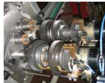
Montaggio e controllo ingranaggi cambio automobilistico.
