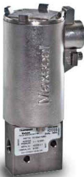
ritorno da 5 kg - tre volte superiore a quelle presenti sul mercato -, che assicura un rapporto di forza di attrito (Force friction ratio - FFR) di 10x. L'intera gamma è certificata Atex Ex de IIC T6-T4 (da -55 a +90°C) e ha una valutazione ambientale IP66/X8 e Nema 4X. Con ogni valvola perfettamente bilanciata, il suo intervallo di pressione d'esercizio è di 0-12 bar
