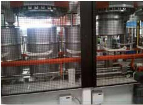
**Linea cilindrico: formatura del foglio di lamiera saldato che costituirà poi il mantello del fusto finito.**
