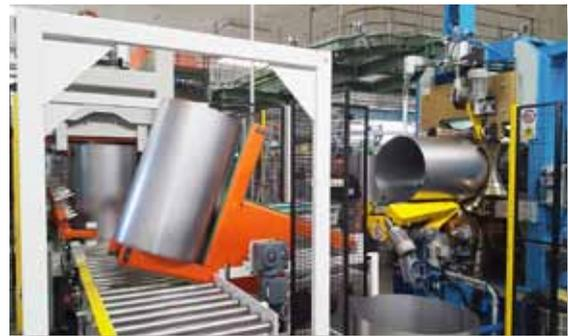
**Linea cilindrico: foglio di lamiera in uscita dalla stazione di saldatura.**
