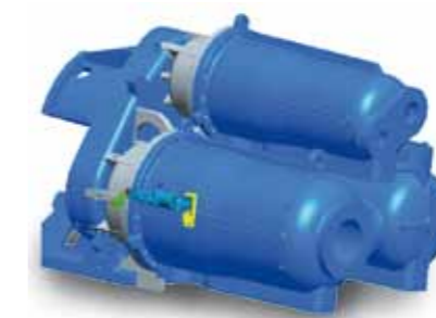
Air-end di un compressore Centac C700.
