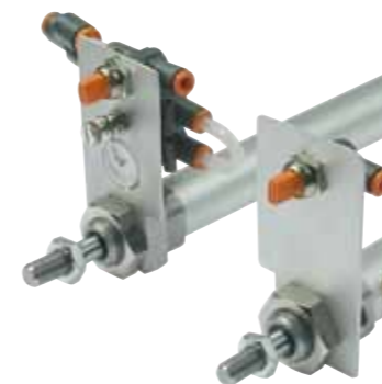
Fig. 2 - La massima miniaturizzazione e modularità si ottiene con la famiglia line-on-line, che comprende regolatori, manometri, valvole elettriche, pneumatiche o manuali, collegabili liberamente in serie o in parallelo. Qui è rappresentato un cilindro Iso 6432 con un pannellino che comprende valvola on-off manuale, regolatore di pressione, manometro ø 22 mm.
