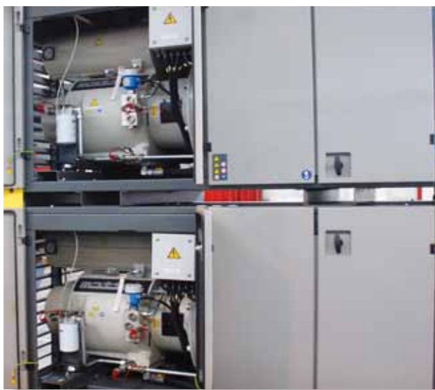
Due compressori M135 all'opera nelle fonderie di alluminio. In primo piano, il sistema push and pull destinato allo scarico dell'olio della macchina.
