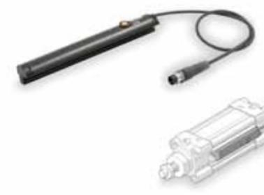
Fig. 1 - Trasduttore di posizione Metal Work serie LTS: fissato nella cava per sensori di cilindri standard, permette di conoscere con precisione la posizione del pistone/stelo. Può essere fissato a varie famiglie di cilindri standard, oltre che ad attuatori rotanti e pinze.
