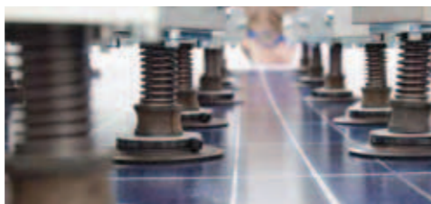
Manipolazione dei wafer con aria compressa.
