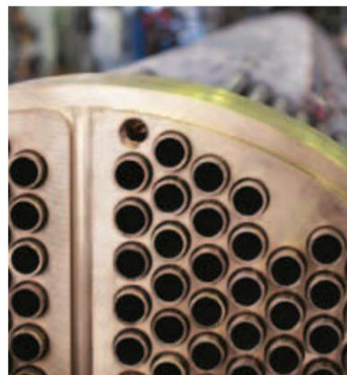
Fascio tubiero in lega di rame per scambiatore servizio ossigeno.
