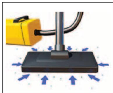
Figura 1 - Un aspirapolvere, di per se stesso, non aspira. L'aria e la polvere sono convogliate all'interno dalla maggiore pressione atmosferica presente all'esterno.
