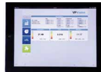
Attraverso un web browser, VPVision 2.0 mostra il completo impianto di aria compressa dal compressore all'utilizzo.
