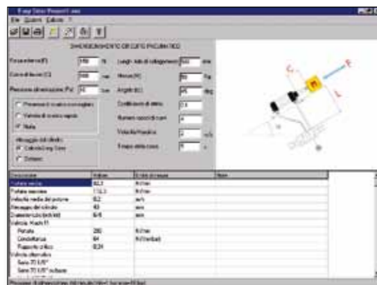
Fig. 3 - Per il dimensionamento dei componenti pneumatici, non si usano programmi Cfd, ma programmi dedicati, semplici e di facile utilizzo, come Easy Sizer, scaricabile gratuitamente dal sito di Metal Work.
