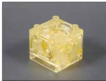
Fig. 2 - I prototipi rapidi, che possono essere costruiti rapidamente e a basso costo, sono talvolta "concorrenti" del Cfd, in quanto premettono di eseguire prove di portata dell'aria reali anziché simularle col calcolo.
