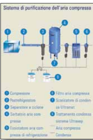
Fig. 1 - In un impianto di purificazione di aria compressa vengono garantiti la rimozione e il trattamento affidabile su tutti i punti di raccolta di condensato.
