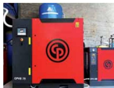
compressore a velocità variabile Chicago Pneumatic CPVS 75, con essiccatore CPX
