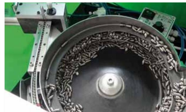
Nuovo sistema Fiam di avvitatura automatica di grani di diverso tipo.
