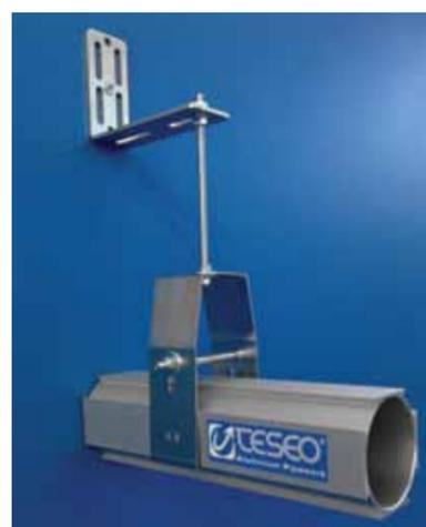
prio interno. Grazie a questa caratteristica, le operazioni di assemblaggio, manutenzione e modifica dell'impianto sono semplificate e velocizzate. Questo tipo di staffa si adatta ottimamente anche alle dilatazioni termiche dovute alle variazioni della temperatura ambientale (giorno/notte, estate/inverno), permettendo il movimento assiale della tubazione.
