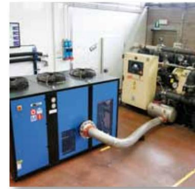
condensa e una serie di valvole e bypass dedicati al "trattamento" dell'aria compressa che hanno il compito di regolare, aggiungere, separare o rimuovere i contaminanti che dovranno poi essere "trattati" dallo specifico prodotto in prova che viene collegato ai capi dell'anello. L'impianto è completato da una sofisticata strumentazione certificata atta alla lettura, registrazione e trasmissione dei dati di funzionamento e dai necessari sistemi di sicurezza che un tale impianto richiede.
