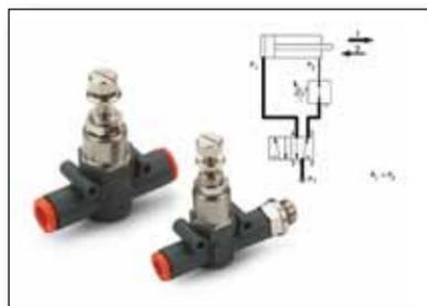
Fig. 2 - Economizzatori serie Rml, Rms e Rmc. La camera del cilindro servita dall'economizzatore viene alimentata alla giusta pressione, risparmiando, quindi, sull'energia necessaria a comprimere l'aria.
