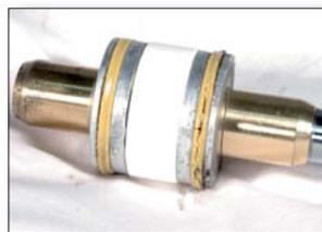
Un danneggiamento della guarnizione di un pistone di cilindro, dovuto al contatto con un olio incompatibile.
