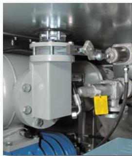
Dispositivo per l'avviamento sotto carico e per il funzionamento intermittente.
