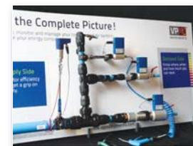
me con VPFlowTerminal, i sensori mostrano il flusso istantaneo attraverso le linee di aria compressa. I valori misurati possono essere conservati per ulteriori analisi e controlli con il sistema VPVision.
