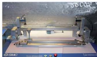
sviluppati per resistere a elevate forze d'inerzia; - cilindro sinusoidale senza stelo Rear, che consente elevate velocità di trasferimento grazie al sofisticato meccanismo di ammortizzo pneumatico.
