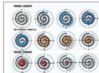
Fig.2 - Sequenza delle fasi di aspirazione, compressione e mandata del compressore scroll.
