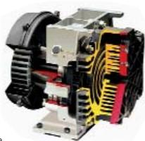
La tecnologia scroll è stata introdotta nel settore dell'aria compressa in tempi relativamente recenti, mentre è largamente impiegata nel settore del condizionamento e refrigerazione da almeno 30 anni ed ha quasi completamente sostituito il compressore alternativo ermetico nelle potenze superiori a 1.2 kW, a dimostrazione dell'affidabilità ed efficienza del sistema di compressione scroll.
