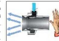
Fig. 5 - Aspetto sicurezza garantito dalla possibilità dell'aria di muoversi in due direzioni.
