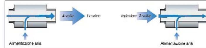
Fig. 3 - Amplifica tre volte in aspirazione e quattro volte in soffiaggio.
