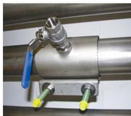
ordinata con varie dimensioni: 120, 160, 220, 300, 400 mm. E' possibile, quindi, usare la sonda VA 400 con tubazioni di diametro interno da 1/2" fino a 12" e maggiori. L'esatta posizione del sensore è ottenuta con l'aiuto di una scala di profondità presente sul bulbo del sensore. La profondità massima è determinata dalla lunghezza del sensore.
