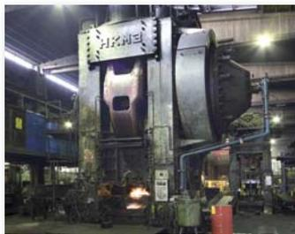
Dettaglio delle linee di stampaggio potenza 6300 tonnellate.
