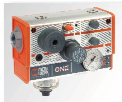
Fig. 2 - Il fattore più importante per ridurre i guasti di componenti pneumatici è l'impiego di aria pulita e controllata. Nella figura, il gruppo One, che, in un unico modulo, filtra, separa la condensa, regola la pressione, fa avviare con gradualità l'impianto, segnala il valore attuale della pressione.
