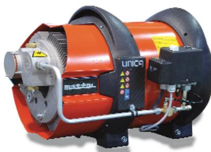
sicurezza e protezione. Tutti i compressori sono, infatti, muniti di un circuito elettrico ausiliario, in bassa tensione, di un termostato per l'arresto automatico del motore in caso di sovra-temperatura della miscela aria-olio, di una valvola di sicurezza per lo scarico dell'aria prodotta in eccesso e di una protezione termica per l'arresto in caso di surriscaldamento del motore.
