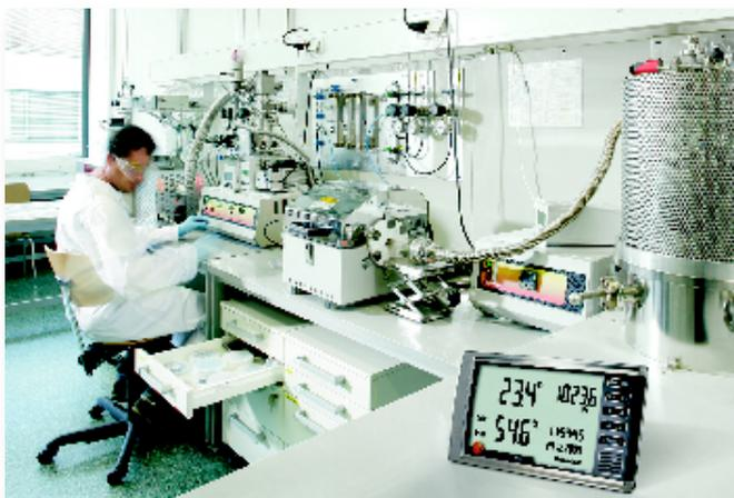
de. Lo strumento visualizza le misure in corso - e i valori precedentemente rilevati - sull'ampio display facilmente leggibile. L'utente può vedere sull'istogramma i valori di umidità o temperatura divisi in intervalli di 1 ora, 2 ore, 12 ore, 1 giorno o 12 giorni e la memoria è in grado registrare i dati delle ultime dodici settimane.
