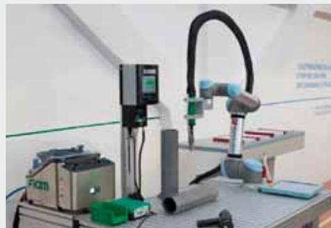
Modulo di avvitatura per Cobot.
