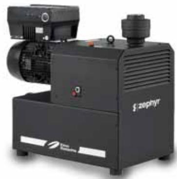
Fig. 3 - C-VLR 501, pompa per vuoto a camme con motore IE3, portata di 495 m<sup>3</sup>/h a 50 Hz, vuoto spinto in servizio continuo 200 mbar (ass). Criteri di ingegneria del suono hanno consentito di ridurre nettamente il livello di pressione acustica.
