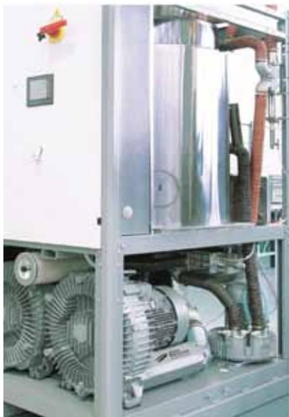
Fig. 1 - Soffiante a canale laterale per l'industria del settore plastico. L'unità compatta, regolabile in funzione del processo, si contraddistingue per elevata portata e bassa rumorosità.
