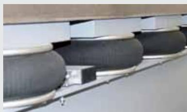
Cilindro a soffietto nell'applicazione Lami-PressVario.
