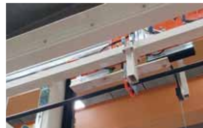
Manipolatore con 2 gripper Kenos KVG 60 che alimentano il dispositivo metti-listello.
