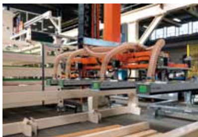
Manipolatore con 4 gripper Kenos KVG 120 che consentono di movimentare uno strato di listelli di legno grezzo.
