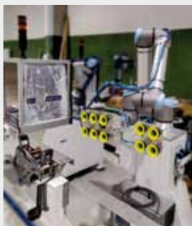
Gripper con le ventose BX e la pompa ad eiettori piCOMPACT®23 SMART di Piab.
