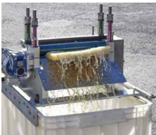
Strizzatura dell'assorbente: si nota il recupero esclusivo dell'idrocarburo.
