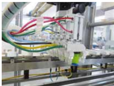
Gripper con le ventose piGRIP BGI25.
